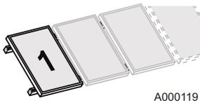
Les capteurs solaires doivent être montés peu de temps avant la mise en service de l'installation solaire. Cela permet de minimiser la durée pendant laquelle les capteurs sont chauffés inutilement, sans fluide caloporteur.
